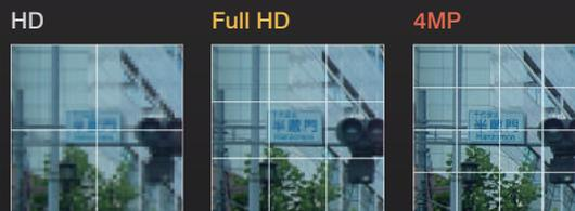
HDのカメラに比べ、Full HDのカメラは約2倍、4メガピクセルのカメラは約4倍の高解像度撮影が可能で、より広範囲で高鮮明な映像を撮影することができます。
